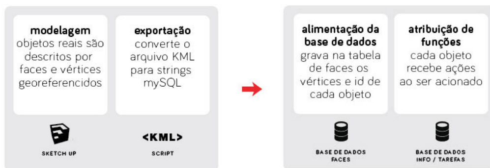
Figura 51 – Descrição da Modelagem e construção da base, utilizando SketchUp, Processing e MySQL
