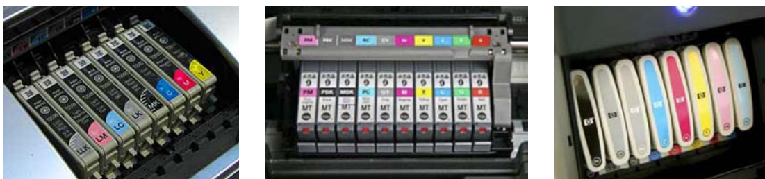
115. Exemplos de jogos de cartuchos coloridos de impressoras jato-de-tinta profissionais dos fabricantes Epson (UltraChrome K3™), Canon (LUCIA™) e HP (Vivera™).
