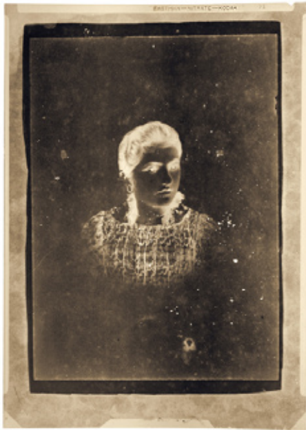
33 - Negativo de celulóide Kodak, marcado "Eastman - Nitrate - Kodak". Nitrate se refere ao suporte de celulóide (nitrato de celulose). EUA, possivelmente na década de 1890.
