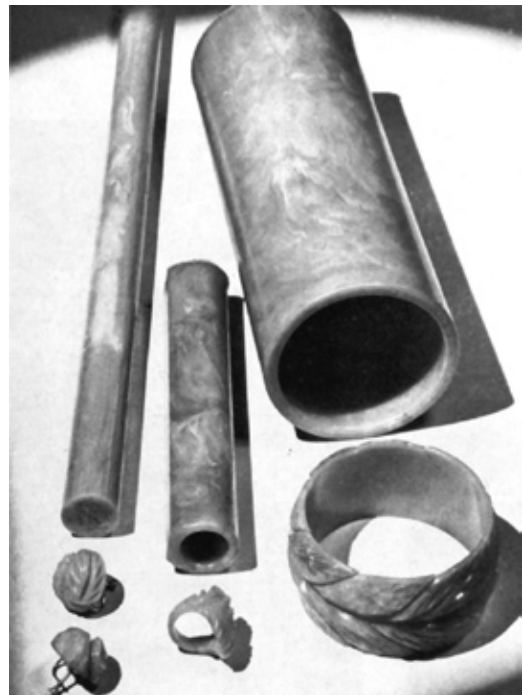
63 - A imagem da década de 1930 mostra as pré-formas de baquelite vazado e os objetos usinados a partir delas.
