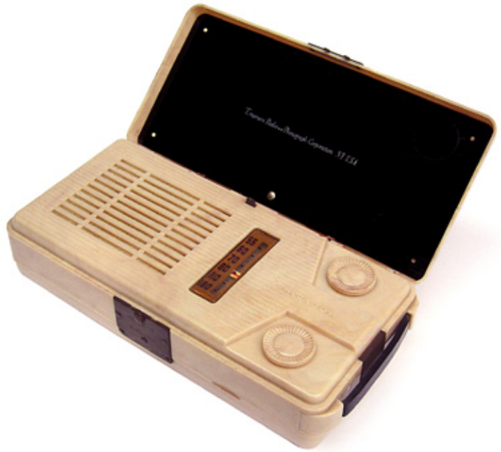
52 - Rádio Emerson Modelo 640. Moldado por injeção em acetato de celulose, que, através da mistura irregular de cores, busca imitar uma textura natural, algo entre o chifre e o marfim. Emerson Radio Co. EUA, c. 1947.
