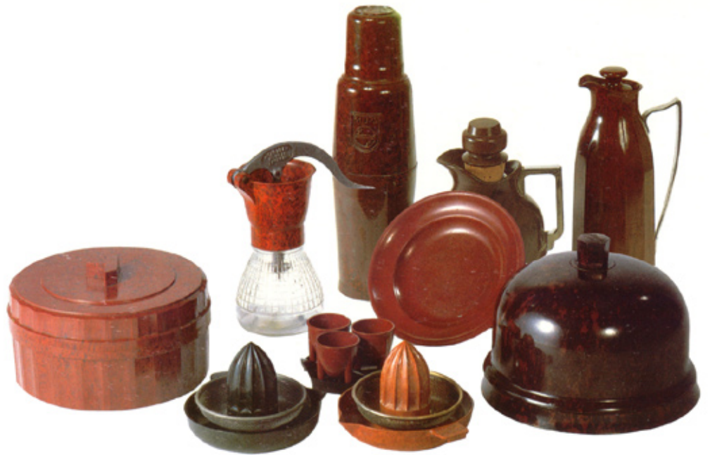
58 - Diversos produtos utilitários domésticos moldados em baquelite. Eles mostram parte da limitada paleta de cores típica do material. Europa na década de 1930.
