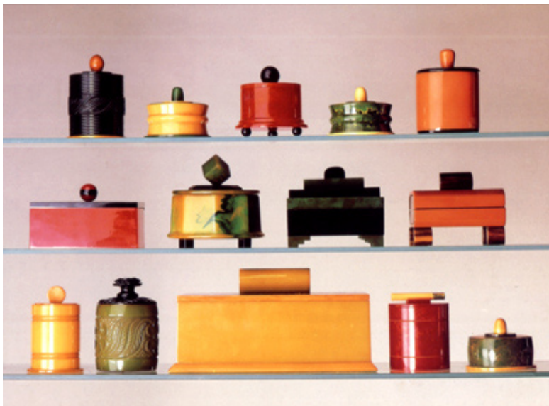
60 - Caixas de baquelite vazado, feitas por usinagem a partir de pré-formas, num trabalho semi-artesanal. EUA, décadas de 1930 e 40.
