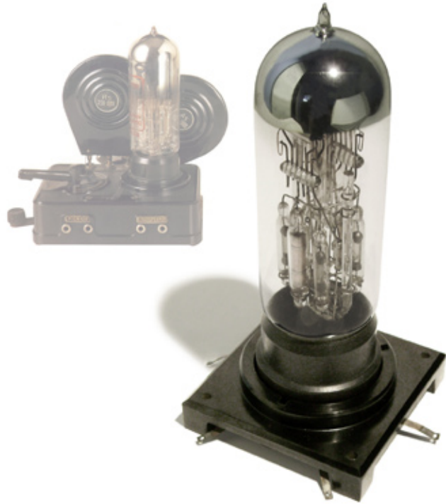
56 - Válvula para rádios Löewe, com base e soquete moldados em baquelite. Ao fundo, um rádio completo, inteiramente moldado no mesmo material. Alemanha, 1926.
