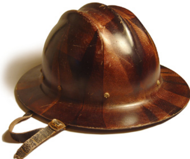
65 - Capacete de segurança moldado em baquelite reforçado com lona, um material compósito. Moldado por Goyana. Possivelmente década de 1940.
