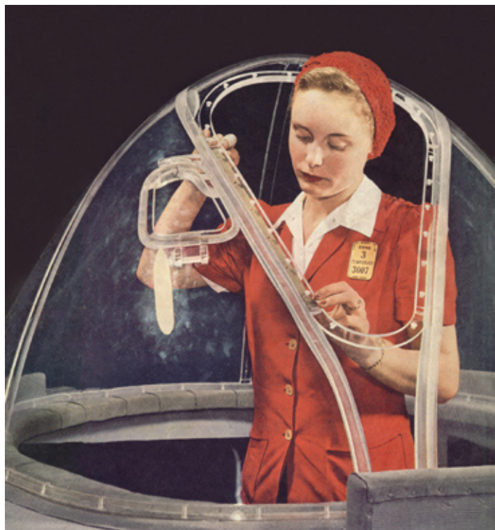
88 - No esforço de guerra a força de trabalho feminina foi ampliada drasticamente. A operária americana monta uma carlinga de acrílico para bombardeiros em 1944.
