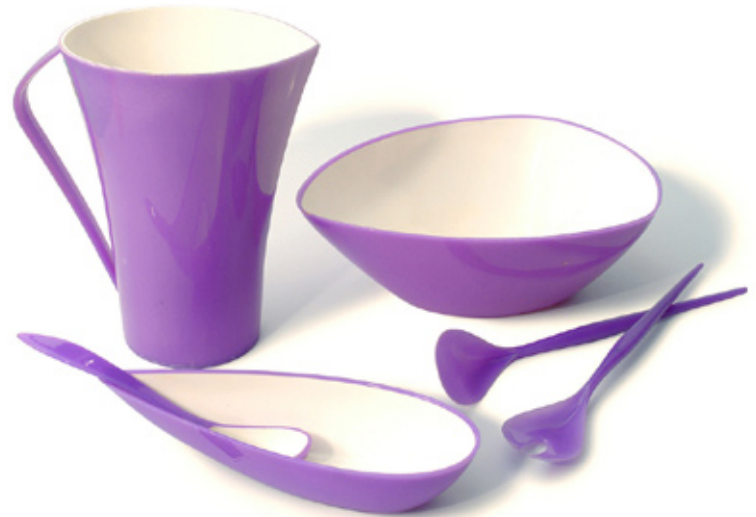
152 - Conjunto de mesa ATMA, lançado em 1961. O material, um tipo de poliestireno injetado, é apresentado com o nome fantasia "Atma-Glass". O diferencial, segundo a divulgação da época, é a nova gama de cores vivas possíveis no material e um brilho superficial superior ao poliestireno conhecido até então. A segunda cor no interior das peças é obtido por um processo de injeção em dois estágios em moldes diferentes.
