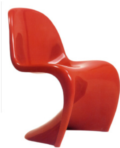
144 - Cadeira Panton, design de Verner Panton, de 1960. Produzida a partir de 1968 em poliuretano rígido; atualmente feita em polipropileno injetado por Hermam Miller e Vitra.
