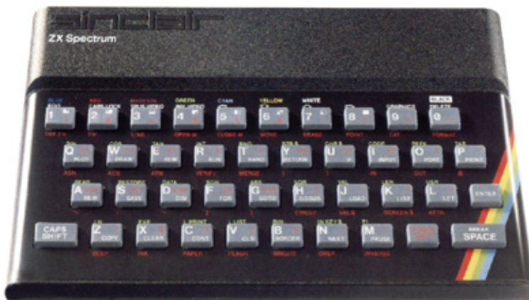
199 - Computador Sinclair ZX Spectrum. Um modelo mais avançado que o modelo original, o ZX 80, de 1980, este modelo apresentava telas em cor. Gabinete em ABS injetado, teclas de borracha. Inglaterra, 1983.
